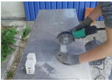
Figura 3.20: Corte dos provetes com a rebarbadora
