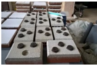
Figura 3.28: Colagem das pastilhas nos provetes
