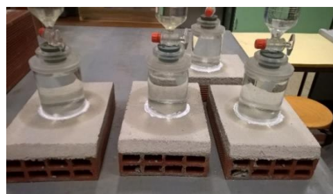
Figura 3.27: Pormenor do ensaio de permeabilidade à água sob pressão após 48 horas
