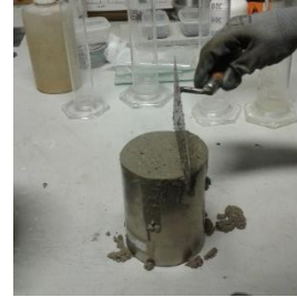
Figura 3.10: Regularização da superfície com colher de pedreiro
