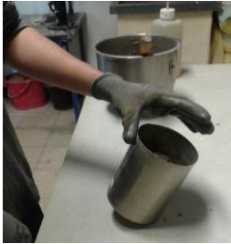
Figura 3.8: Compactação da primeira camada de argamassa por oscilação do recipiente cilíndrico
