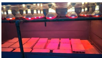
Figura 3.32: Provetes na câmara de envelhecimento acelerado: ciclo de calor – gelo
