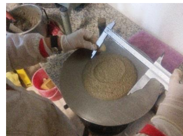
Figura 3.7: Medição do diâmetro da argamassa com a craveira
