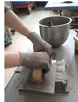
Figura 3.4: Regularização da superfície do molde
