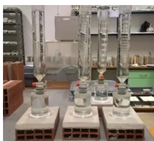
Figura 3.26: Vista geral do ensaio da permeabilidade à água sob pressão
