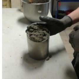
Figura 3.9: Compactação da segunda camada
