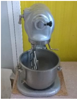
Figura 3.1: Misturadora utilizada para a realização de amassaduras
