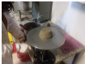
Figura 3.6: Aplicação de 15 pancadas por rotação do manípulo da mesa de espalhamento
