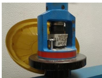
Figura 3.18: Acessório para ensaio de resistência à compressão
