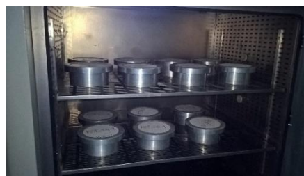
Figura 3.25: Conjuntos de copos de ensaio e provetes na câmara climática
