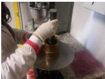
Figura 3.5: Compactação da argamassa com o pilão
