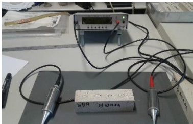
Figura 3.14: Equipamento utilizado no ensaio de ultra-sons
