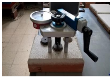
Figura 3.29: Posicionamento do dinamómetro de arrancamento
