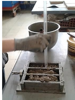
Figura 3.2: Compactação da primeira camada
