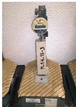
Figura 3.23: Medição do comprimento do provete com o deflectómetro
