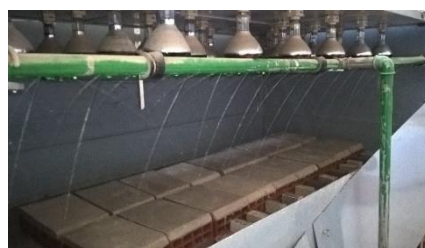
Figura 3.33: Provetes na câmara de envelhecimento acelerado: ciclo de gelo – degelo
