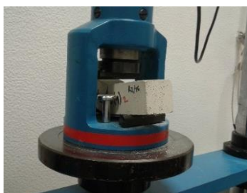
Figura 3.17: Acessório para ensaio de resistência à tracção por flexão
