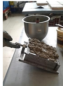
Figura 3.3: Compactação final por elevação do molde
